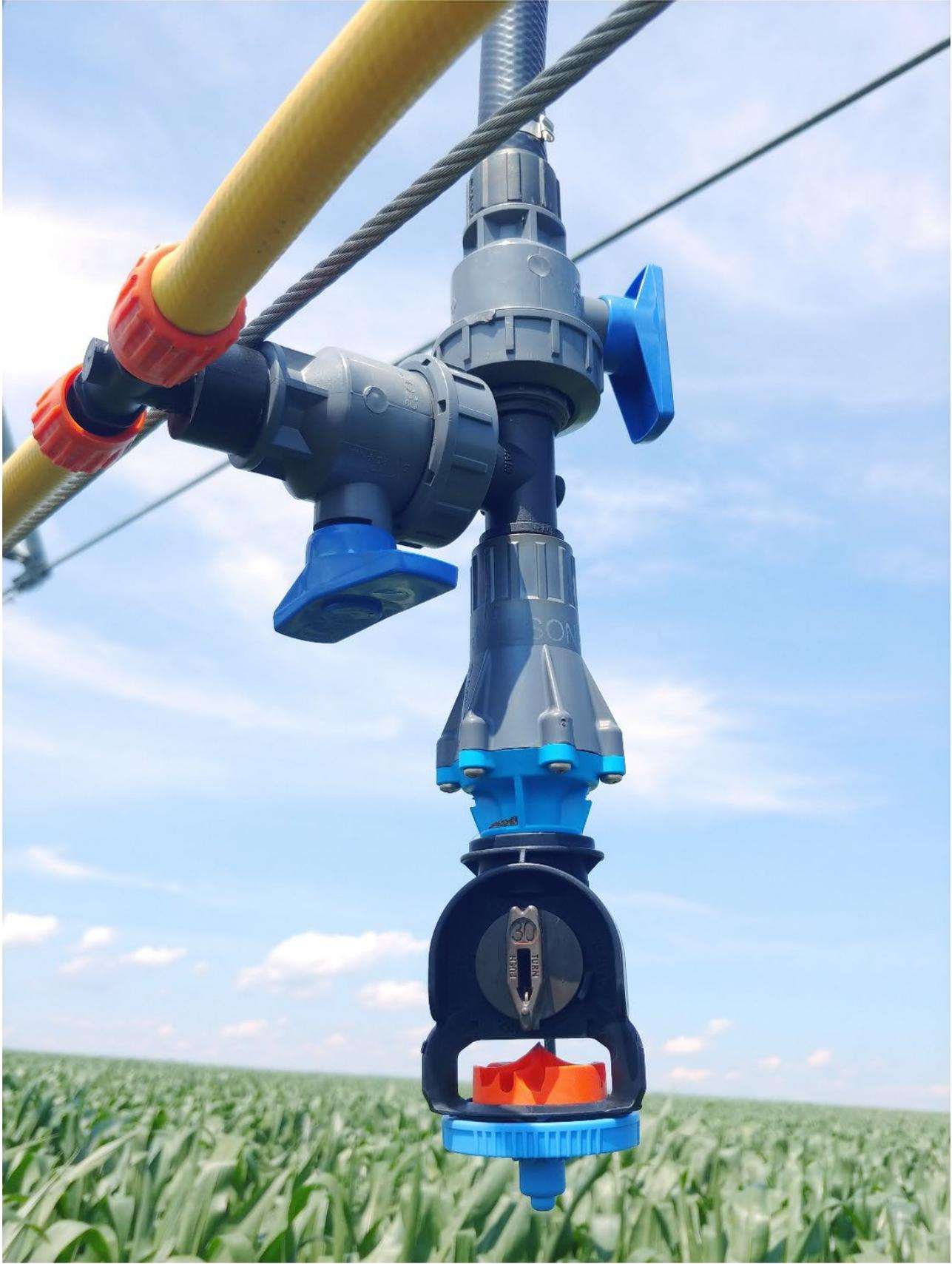
Figure 19. Montage de système hybride sur les pendillards du pivot (tuyau noir), T à compression sur la ligne d'eau secondaire.
