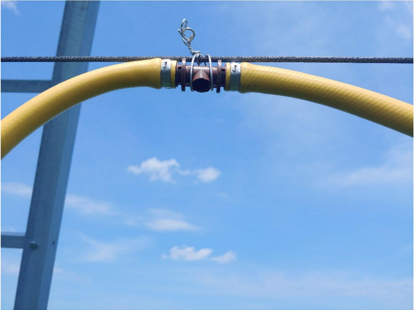
Figure 24. Bris mécanique du T à insertion dû au maintien des tubes g-à-g au sol par le gel.
