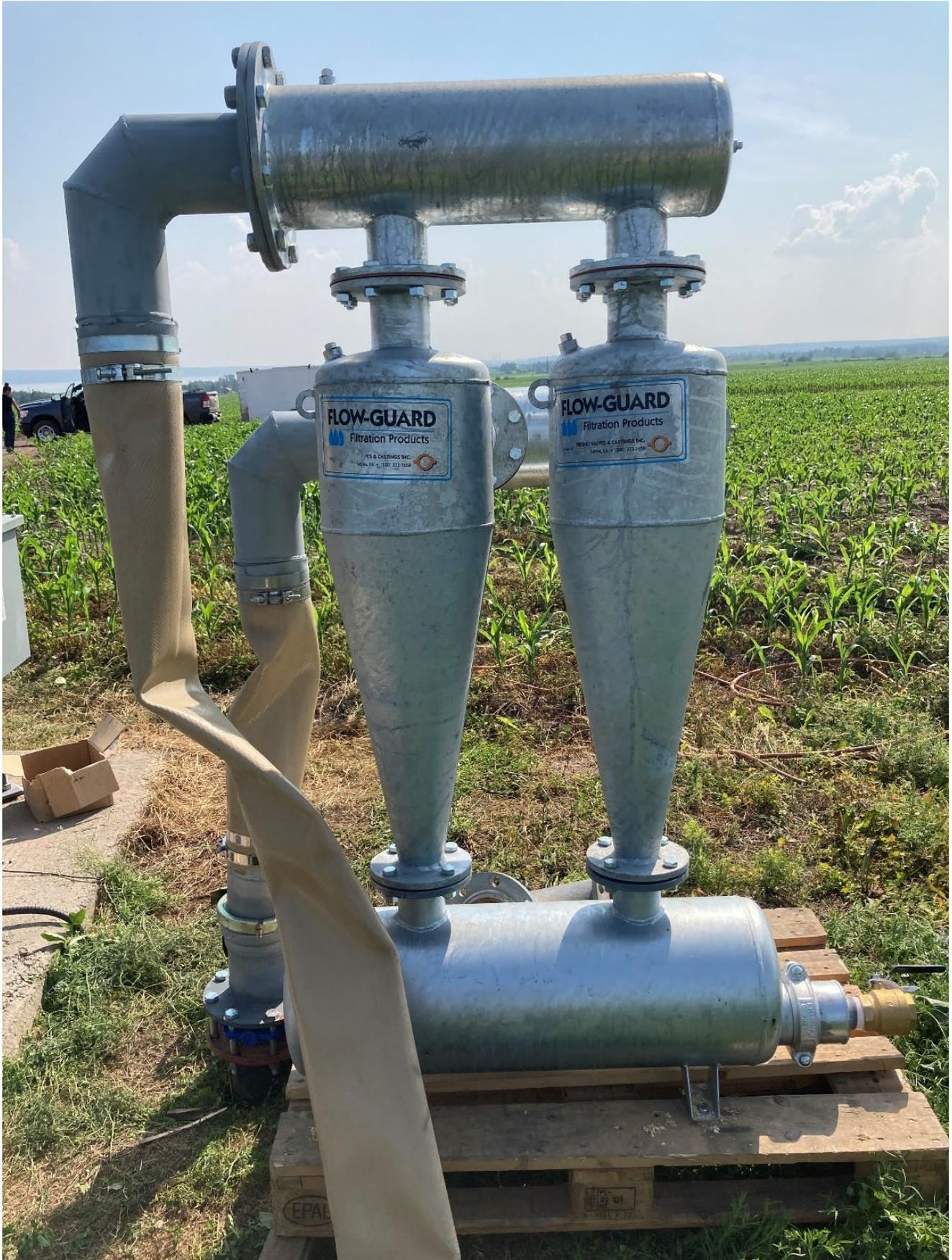
Figure 21. Système cyclonique de prétraitement de l'eau (séparateur de sable).
