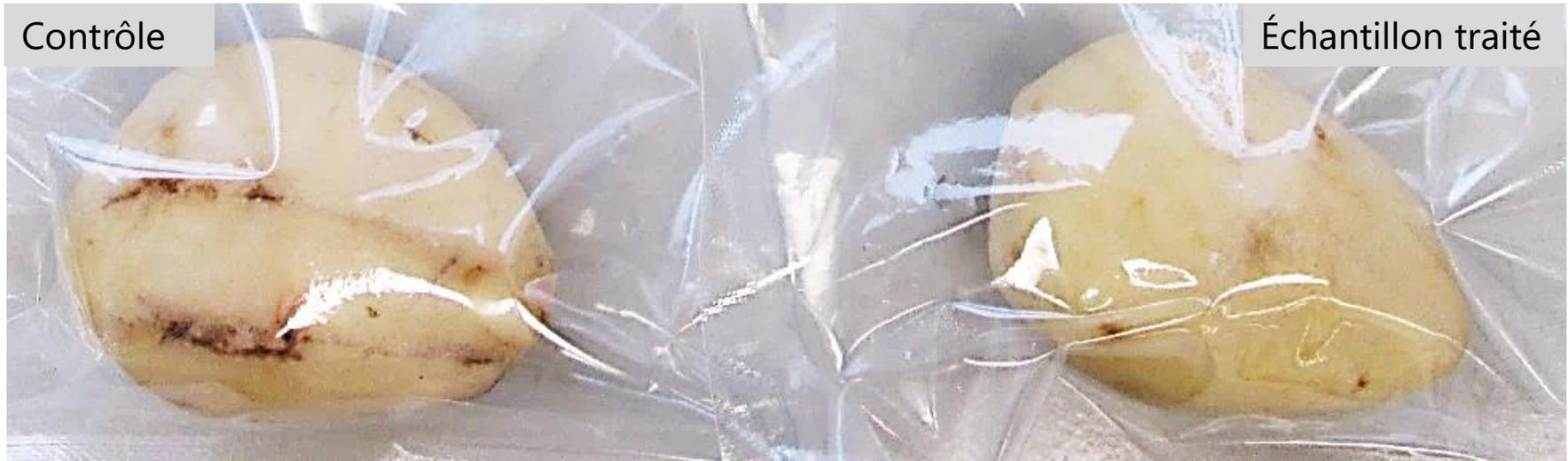
Traitement par la lumière pulsée sur le convoyeur pendant 5 secondes
