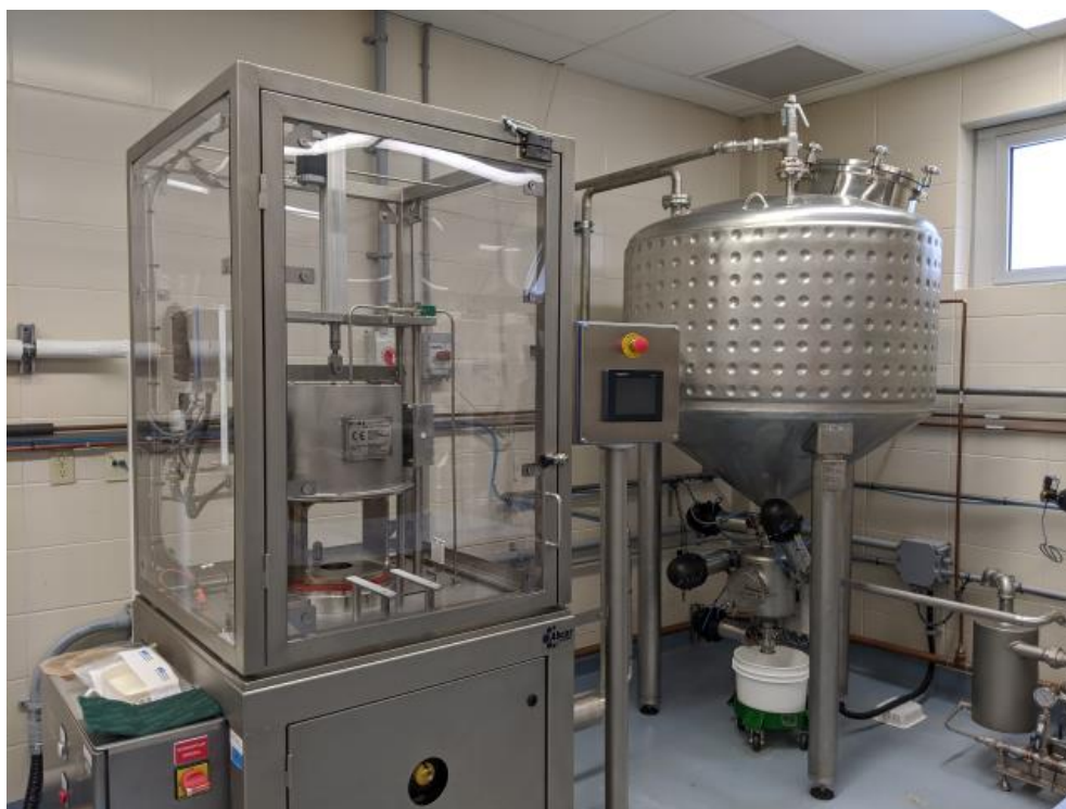
Figure 11 : Équipement de détente instantanée à l'échelle pilote chez Cintech agroalimentaire
